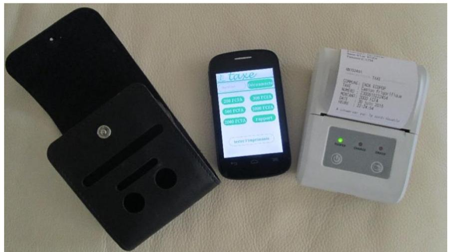
Le **terminal** inclut à la fois un téléphone portable doté d'une puce 3G et une mini-imprimante. La technologie 3G permet une connexion online par un accès mobile et un
